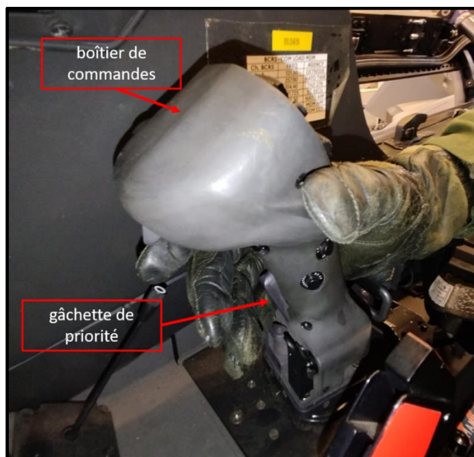
Figure 32 : pré-positionnement conventionnel de la main et gâchette de priorité sur le mini-manche
