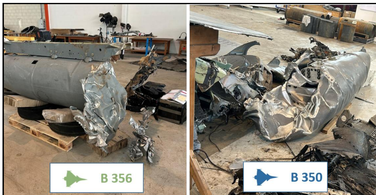
Figure 12 : dégâts constatés sur les bidons de carburant ventraux
