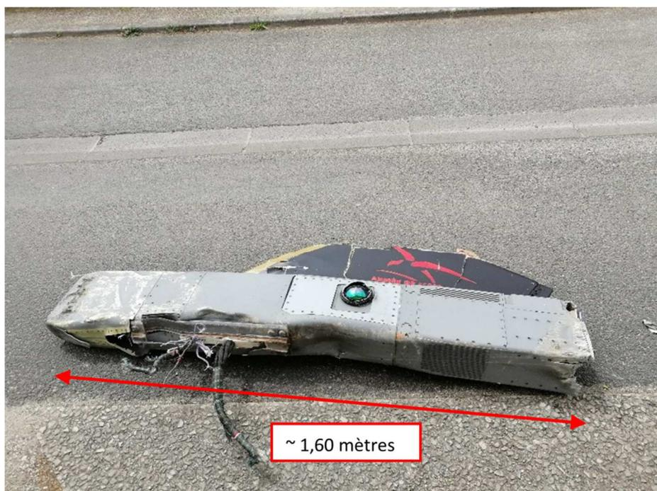
Figure 8 : partie haute de la dérive de l'équipier retrouvée à Gensac-la-Pallue
