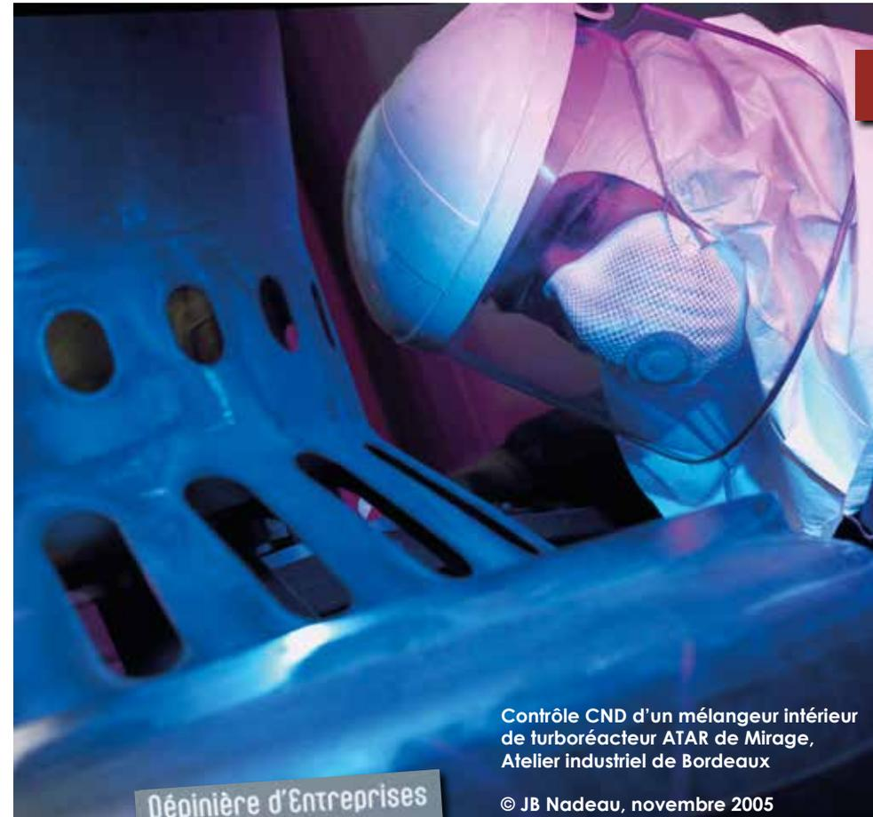
Contrôle CND d'un mélangeur intérieur de turboréacteur ATAR de Mirage, Atelier industriel de Bordeaux
