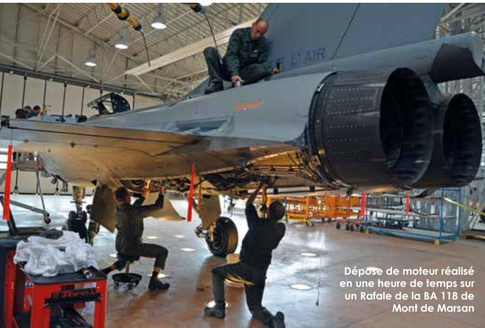
Dépense de moteur réalisé en une heure de temps sur un Rafale de la BA 118 de Mont de Marsan
