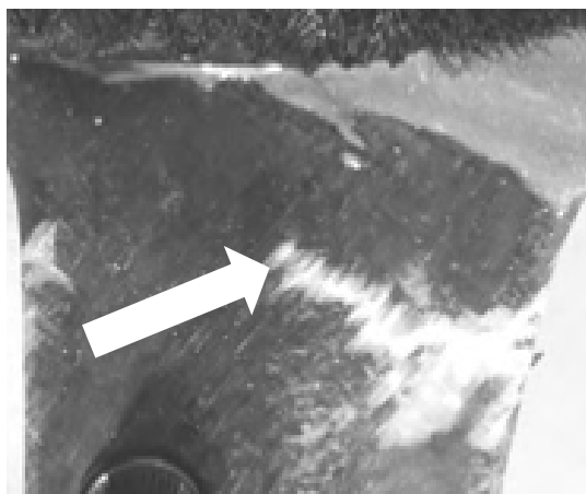
Exemples de traces blanches sur l'arceau carbone du calotin.
