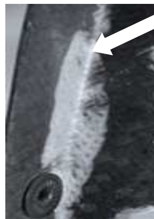
Exemples de traces blanches sur l'arceau carbone du calotin.
